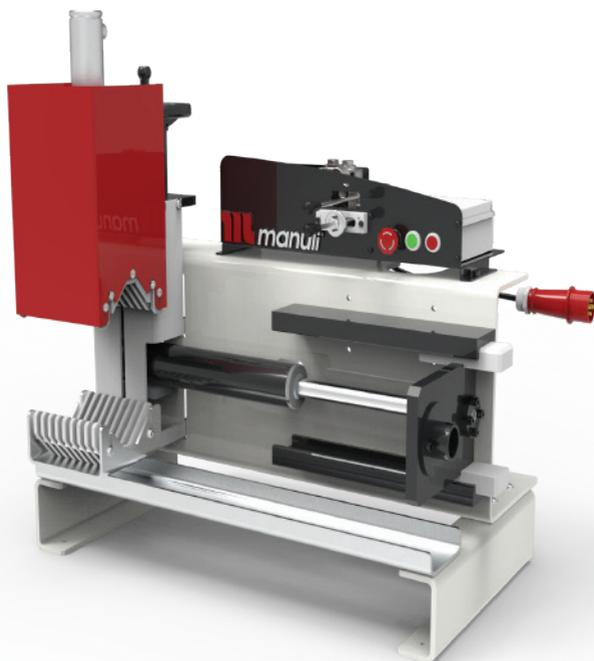
Le nostre attrezzature per l'inserimento dei raccordi eliminano lo sforzo e l'incertezza dalla realizzazione di assemblaggi di tubi flessibili, assicurando che i raccordi siano completamente inseriti prima della crimpatura.
