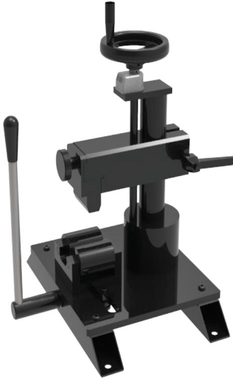
Garantite la completa tracciabilità con le nostre attrezzature per la marcatura delle ghiera, complete di un set completo di punzoni alfanumerici e caratteri aggiuntivi.
